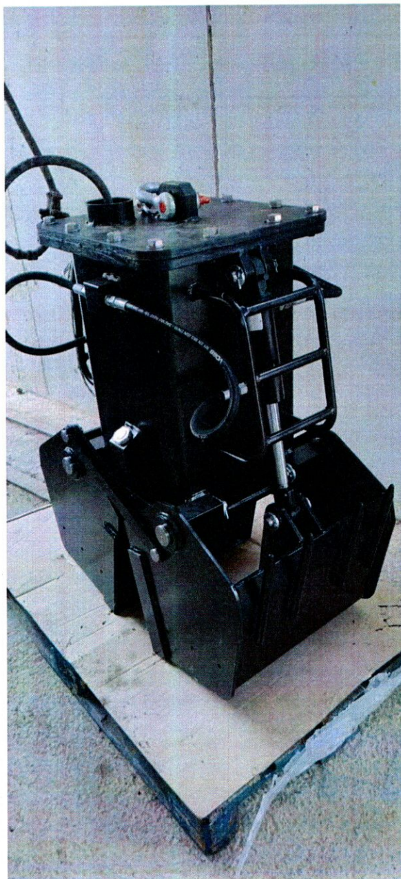
Fotografía de la izquierda con la cuchara bivalva nueva y de la derecha con la cuchara antigua inservible ya desconectada y la nueva ya instalada y en funcionamiento
