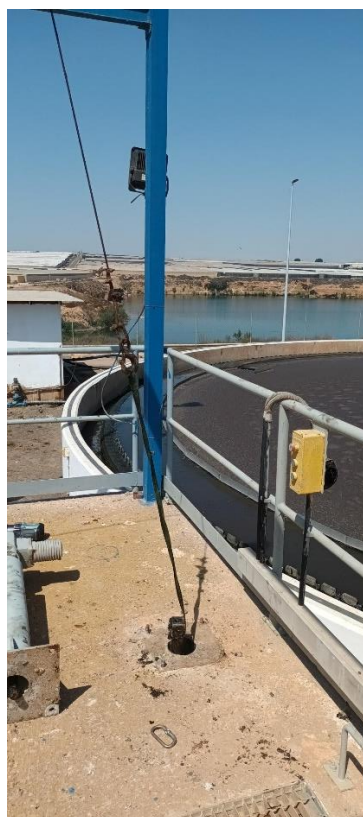
Husillo de accionamiento de la compuerta doblado, después de haberse roto a la altura del accionamiento de la compuerta
