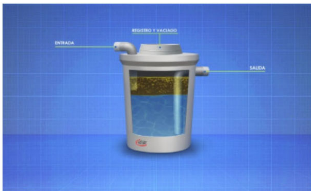
Detalle de separador de grasas.
