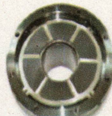
Rodamiento de perfil sin contacto. Cojinete de empuje con cojinete radial insertado
