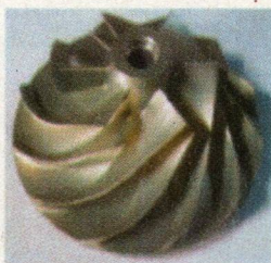
Aleación de aluminio forja el impulsor
