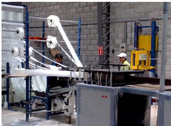
Detalle de la maquinaria utilizada en la Pultrusión.
