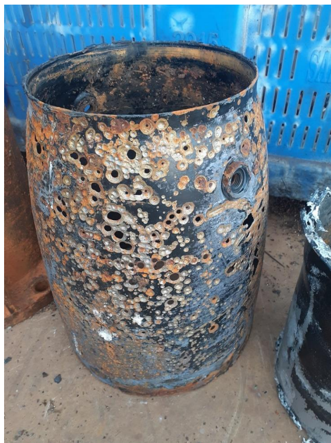
Carcasa exterior de la bomba agujereada
