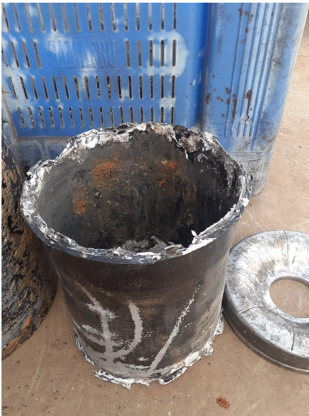
Cuerpo de la bomba, muy descompuesto
