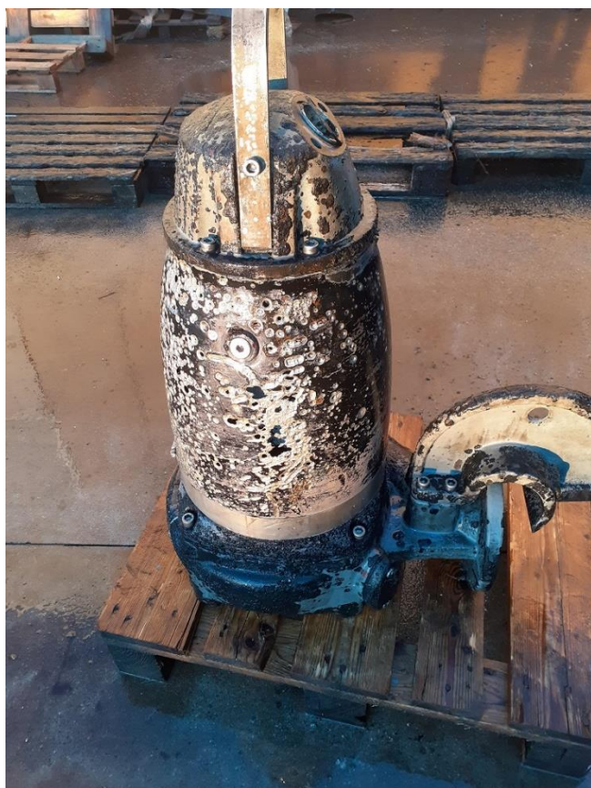
Carcasa exterior de la bomba agujereada
