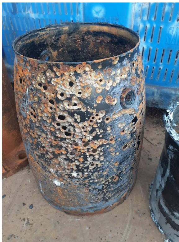
Carcasa exterior de la bomba agujereada
