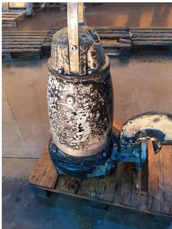
Carcasa exterior de la bomba agujereada
