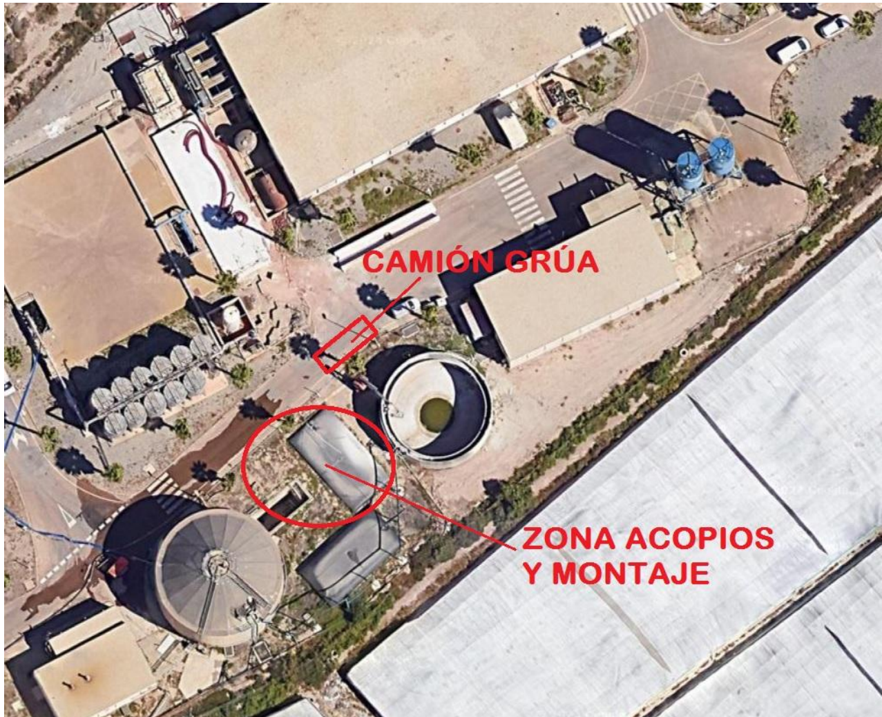
ZONA DE ACOPIOS Y MONTAJE DE CUBIERTA
