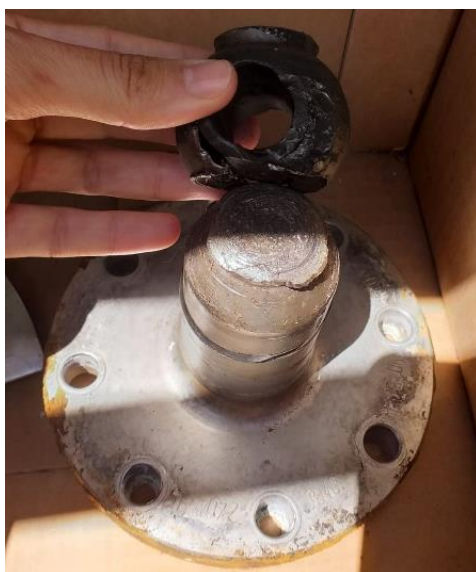
Ilustración 1: Eje accionamiento roto (pieza 38C).
