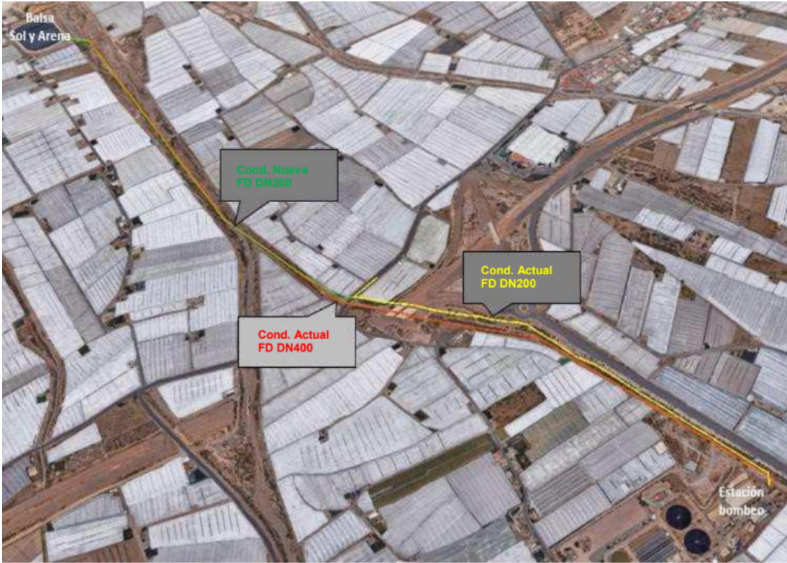
Esquema red de distribución de agua regenerada
