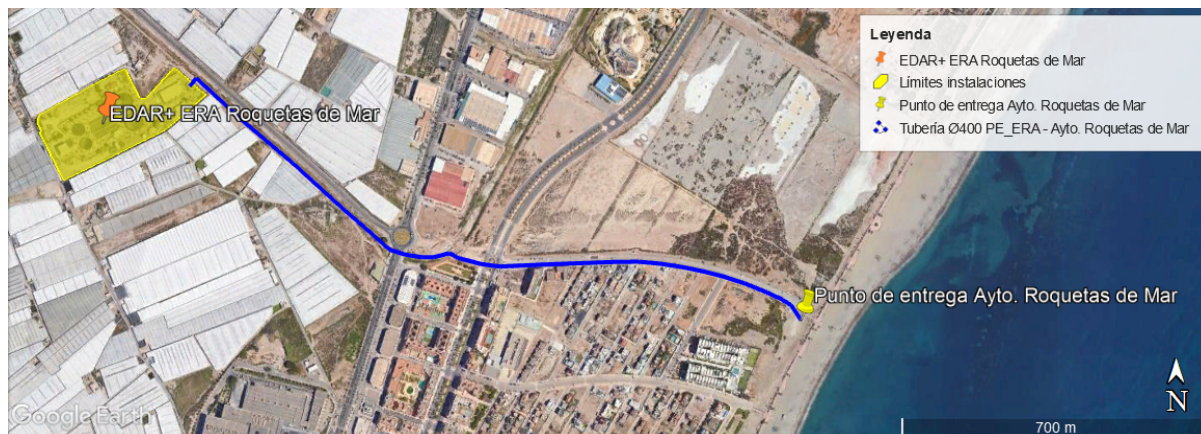
Foto: Tubería de distribución del agua desde la EDAR+ERA al Ayuntamiento de Roquetas de Mar.
