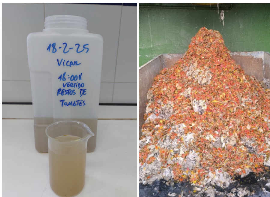
Foto izquierda: vertido detectado por el colector de Vúcar. Foto derecha: restos de tomate en los desbastes de la EDAR.
