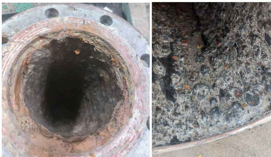
Estado inicial de la tubería con sección reducida que impedía la circulación de fango por su interior y que motivó la actuación de emergencia.
